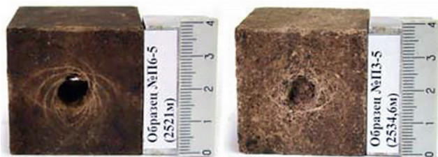
Рисунок 3 Моделирование образования системы трещин в ядрах при создании депрессии в твердых и менее прочных породах [4]
